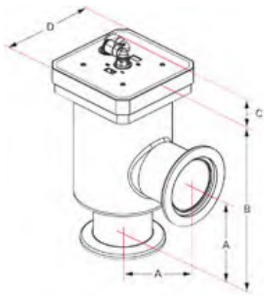
Abb. 2: Abmessungen Ventil N-Series NAP Abmessungen in mm
